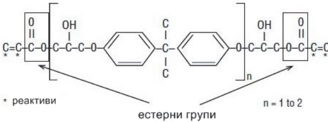
Фиг. 4. Идеализираната химична структура на един типичен винилестер
