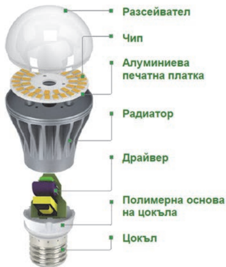
Фиг. 1. Конструктивни елементи на светодиодна лампа
